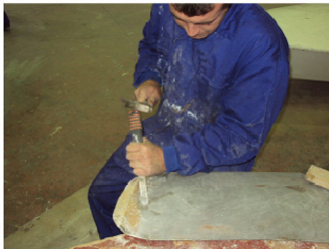
Reparación de palas de timón
