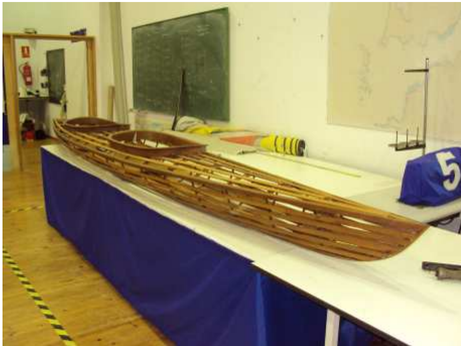
Deseño, desenvolvemento e construción dunha piragua polo método do alistonado.
