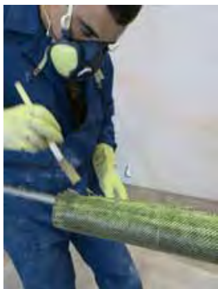
◀ Laminación exterior con Kevlar-Carbono
