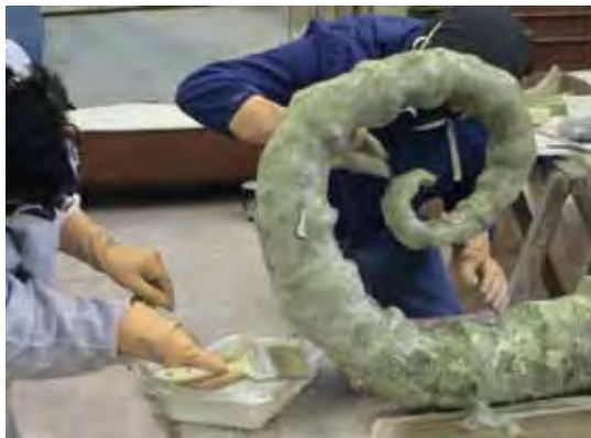
▲ Aplicación capas de fibra de vidro
