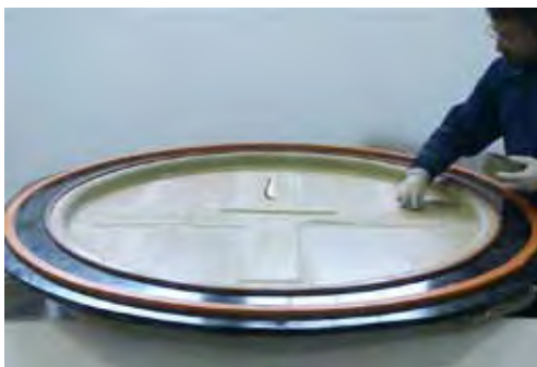
▲ Aplicación de cera desmoldeante
