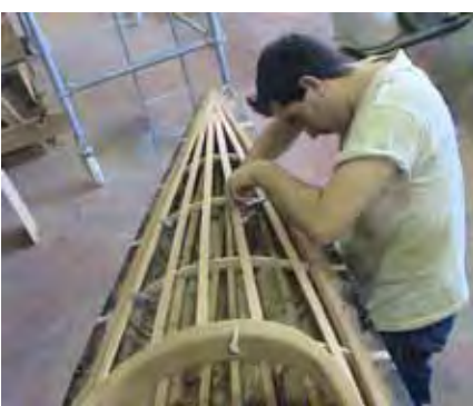
▲ Colocación listóns piragua
