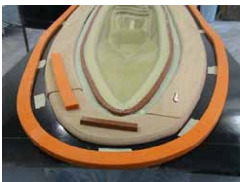
▲ Colocación elementos desechables para fabricación contramolde
