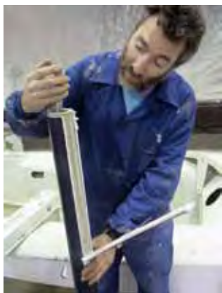
◀ Introducción nucleo para reparación botolón
