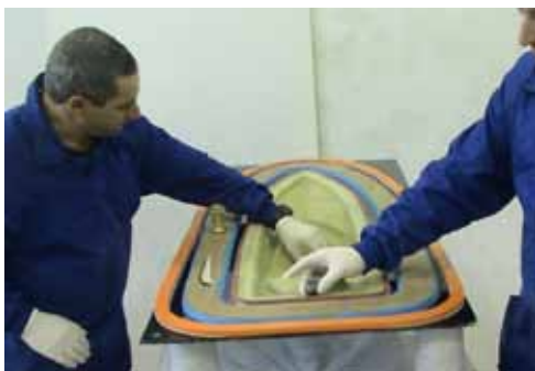
▲ Colocación de boquillas metálicas de inyección
