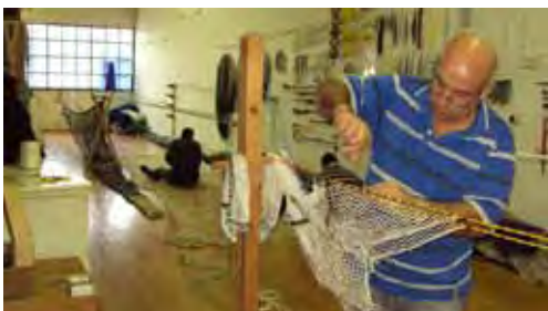
▲ Armado de tralla
