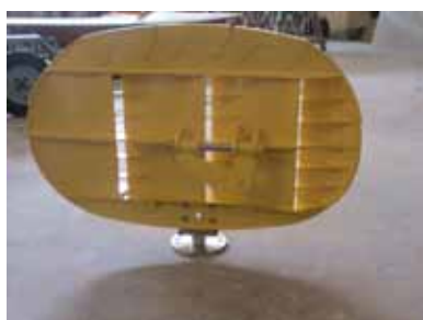
Porta de arrastre a escala acabada en pintura de poliuretano
