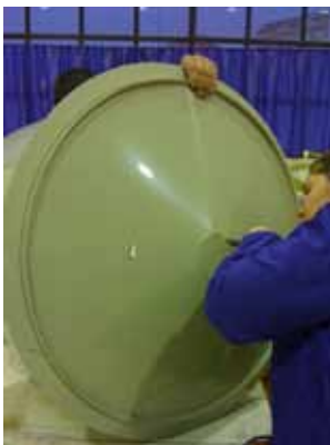
◀ Acabado fondo tanque
